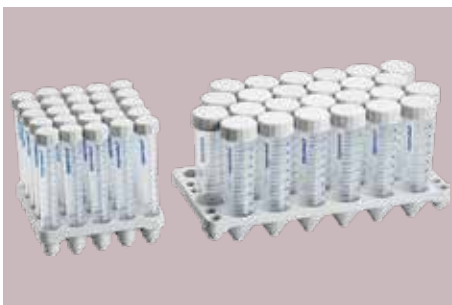
ラック入りの 15 mL コニカルチューブと 50 mL コニカルチューブ。
