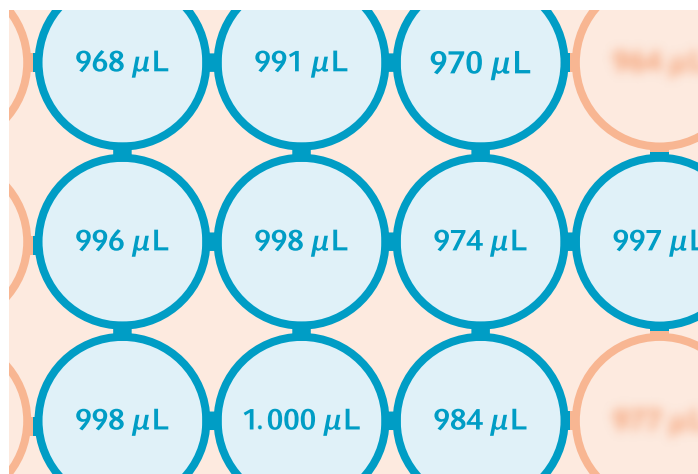
Zehn Messungen – Mittelwert 984 µL, 1,6 % Fehler
