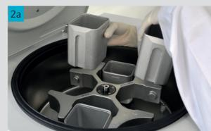
Remova as caçapas e o rotor. Para centrífuga refrigerada:
