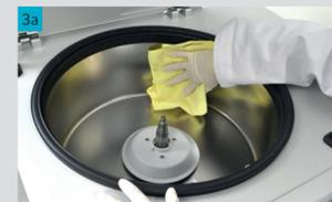
Limpe a câmara e eixo do rotor com detergente neutro suave ou use álcool 70° para desinfetar.
