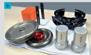
Coloque as peças de cabeça para baixo para secar. Para evitar que a tampa antiaerossol fique desgastada/danificada, mantenha as tampas separadas das caçapas e rotores.
