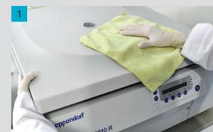
Desligue a centrífuga e limpe seu exterior com detergentes suave.
