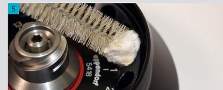
Se necessário, o rotor, tampa, caçapas e adaptadores podem ser autoclavados a 121 °C, 20 min. (nunca use UV, radiação gama BETA, ou qualquer radiação de alta energia). Limpe o rotor com pano úmido sem fiapos e detergente diluído, álcool 70°, ou álcool contendo detergente. Depois, limpe os selos com pano molhado e enxague completamente com água destilada. Use escova de ponta não metálica para limpar os furos do rotor.
