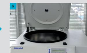
Deixe a tampa da centrífuga aberta a noite toda para evaporar a condensação.
