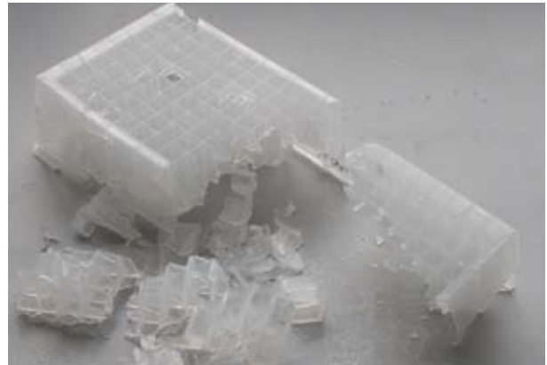
Abbildung 2: Zersplitterte Wettbewerber-Platte nach Zentrifugation mit 70 %-igem Ethanol (4 °C, 90 Minuten) bei 6.189 x g in Zentrifuge Sigma 4K15C Rotor 09100.
