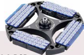
S-96x0,2-PCR PCR-Ausschwingrotor für 12 x 8 PCR-Streifen 0,1/0,2 mL oder 4 x ¼ twin.tec-PCR-Platten 96, unskirted teilbar oder 96 x PCR-Gefäße mit 0,2 mL Max. Drehzahl: 6.000 rpm/3.217 x g
