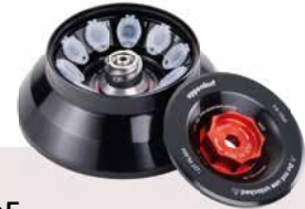
FA-10x5 Eppendorf QuickLock®-Rotor, aerosoldicht, für 10 x 5,0-mL-Gefäße* Max. Drehzahl: 15.060 rpm/21.330 x g; nimmt Adapter für 1,5/2,0-mL-Gefäße, HLPC-Gefäße und Cryo-Gefäße auf
