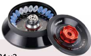
FA-24 x2 Eppendorf QuickLock®-Rotor, aerosoldicht, für 24 x 1,5/2,0-mL-Gefäße Max. Drehzahl: 15.060 rpm/21.330 x g
