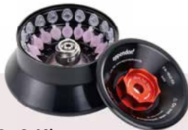
FA-18x2-Kit Eppendorf QuickLock®-Rotor, aerosoldicht, für 18 x Spin Columns und 1,5/2,0-mL-Gefäße mit besonders hohem Rand, unterstützt die Zentrifugation mit offenen Deckeln; Drehzahl bis zu 15.060 rpm/18.565 x g
