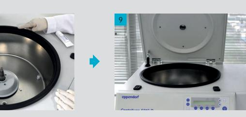
Lasciare aperto il coperchio della centrifuga durante la notte per permettere alla condensa di evaporare.
