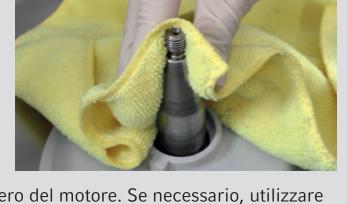
Rimuovere i cestelli e il rotore. Per le centrifughe refrigerate:
