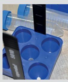
Adattatore per provette coniche > base conica
