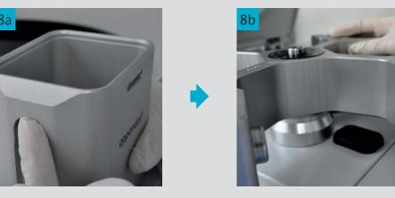
Lubrificare le scanalature del cestello 8a, i perni 8b e la guarnizione in gomma 8c. Verificare che non sia necessario sostituire le guarnizioni dei tappi/coperchi a tenuta di aerosol. La tenuta di aerosol è garantita se le guarnizioni sono integre e prive di danni. Lubrificare i filetti dei rotori ad angolo fisso dopo aver effettuato la pulizia e il trattamento in autoclave.
