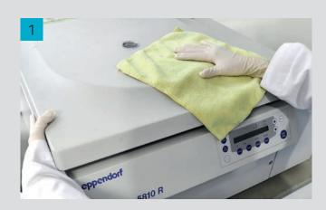
Spegnere la centrifuga e pulire con un panno umido. Se necessario, utilizzare detergenti delicati.
