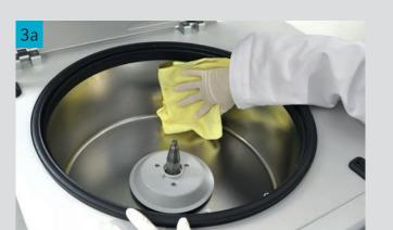
Pulire con un panno la camera del rotore e l'albero del motore. Se necessario, utilizzare un detergente neutro delicato o dell'alcool al 70 % per la disinfezione. **Nota: STACCARE** LA SPINA della centrifuga prima di utilizzare soluzioni detergenti.
