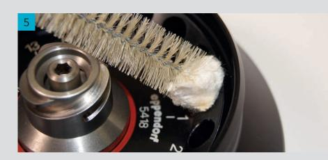
E' possibile mettere in autoclave rotore e relativi accessori a 121 °C per 20 min. (Non usare mai raggi UV, beta, gamma o qualunque fonte di radiazione ad elevata energia.) Pulire il rotore, il coperchio del rotore, la guarnizione in gomma, i cestelli e gli adattatori con un panno inumidito con del detergente diluito o dell'alcool. Si raccomanda di sciacquare tutte le parti con acqua distillata e di utilizzare uno scovolo con punta non metallica per pulire gli alloggiamenti delle provette.
