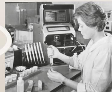
Nach dem Erfolg der Mikroliterpipette entwickelt Eppendorf ein komplettes Mikroliter-System, bestehend aus Reaktionsgefäßen, Mischern, Zentrifugen und Pipetten. Die Pipettierarbeit kann jetzt schneller, präziser und mit einem Bruchteil des vorher benötigten Probenvolumens durchgeführt werden.
