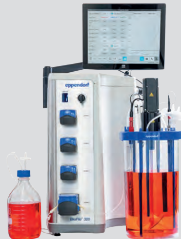
BioFlo 320 ワーキングボリューム：0.6～10.5L (オートクレーブ対応) 0.25～40L (シングルユース)
