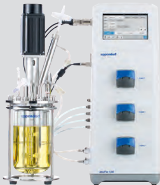
BioFlo 120 ワーキングボリューム：0.4～10.5L (オートクレーブ対応) 0.25～40L (シングルユース)
