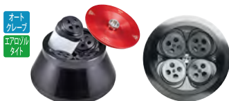
R9A2 (CR30NX/CR22N専用) 1,500mL×4本、8,500rpm/15,100×g、 質量 17.1kg ¥ 2,390,000
