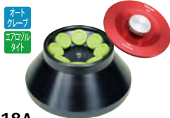
R18A 50mL×8本、18,000rpm/42,200×g 質量 8.2kg ¥ 604,000
