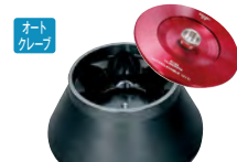
R10A3 500mL×6本、10,000rpm/18,800×g、 質量 14.6kg ¥ 1,140,000
