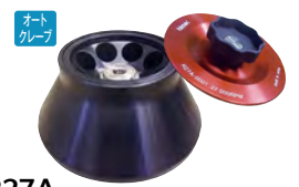
R27A 50mL×8本、27,000rpm/ 88,400×g (CR30NX) 質量 6.9kg ¥ 675,000
