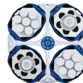
Adapter uniwersalny 3 Konfiguracja dla probówek stożkowych 50 mL i butelek 250 mL.
