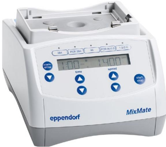
**¿Requiere una mezcla directa?** El mezclador 3 en 1 para placas, tubos y mezcla con vórtex. Este equipo de alta velocidad proporciona una mezcla completa de sus muestras en segundos. El notable <sup>2D</sup>Mix-Control permite una mezcla optimizada con tecnología antiderrame.
