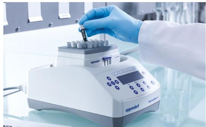
Utilice el Eppendorf ThermoMixer® C para calentar, enfriar y mezclar sus muestras. Varios Eppendorf SmartBlocks aumentan la flexibilidad de los recipientes desde placas de 384-well a tubos de 50 mL.
