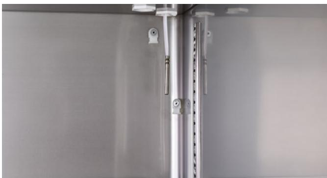
**¿Doble seguridad para las muestras?** La sonda de temperatura integrada puede ser apoyada por el sistema de medición de temperatura independiente de VisioNize® sense
