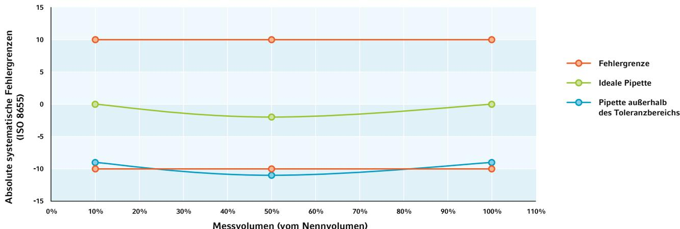
Gemäß ISO 8655 ist die Kalibrierung mit drei Prüfvolumina durchzuführen: mit dem Nennvolumen, mit 50 % und mit dem kleinsten einstellbaren Volumen oder 10 % des Nennvolumens (je nachdem, was größer ist). Da die Fehlergrenzen einer Pipette nicht linear vom Minimal- zum Maximalvolumen verlaufen, kann es vorkommen, dass das 10%- und das 100%-Volumen innerhalb der systematischen Messab-
