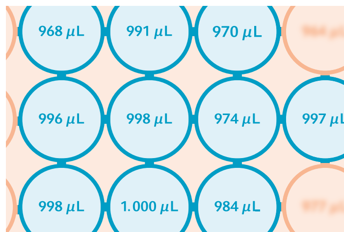
Zehn Messungen – Mittelwert 984 µL, 1,6 % Fehler
