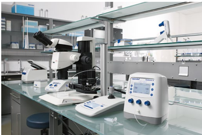
Arbeitsplatz für die Mikroinjektion in kleine Organismen
