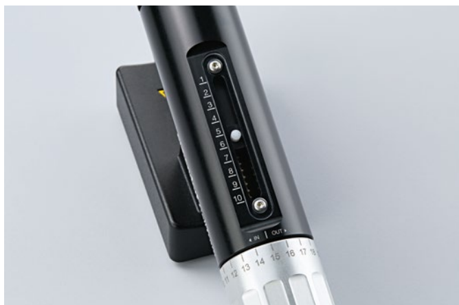
CellTram 4r Air: la risposta di pressione per diverse applicazioni può essere regolata con posizioni del pistone diverse
