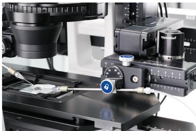
El ángulo de inyección puede ajustarse de 0 ° a 90 °. Esto garantiza la máxima flexibilidad para diversas aplicaciones.
