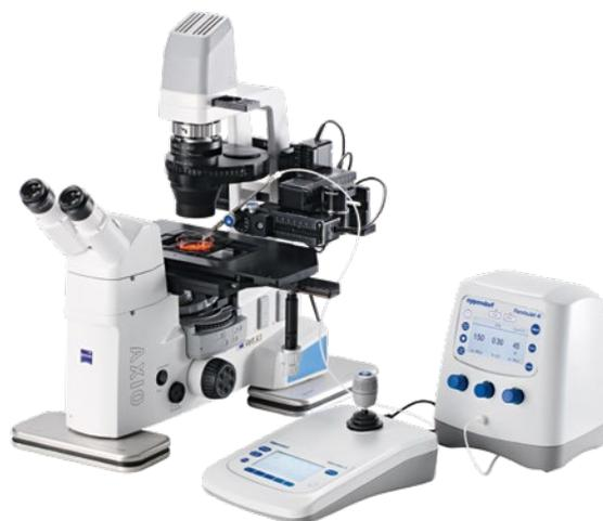
Estación de trabajo para inyección de células adherentes
