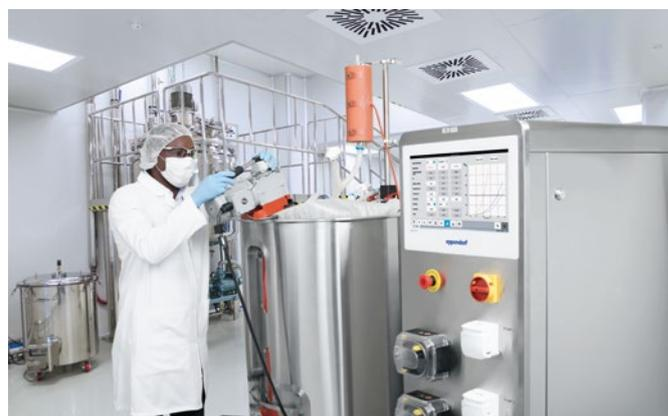
El BioFlo® 720 proporciona un potente controlador con opciones avanzadas para procesos de solo uso a escala de planta piloto o de producción. ¡El módulo de asistencia para el escalamiento y la calibración automática de los sensores de OD también facilitan su uso!
