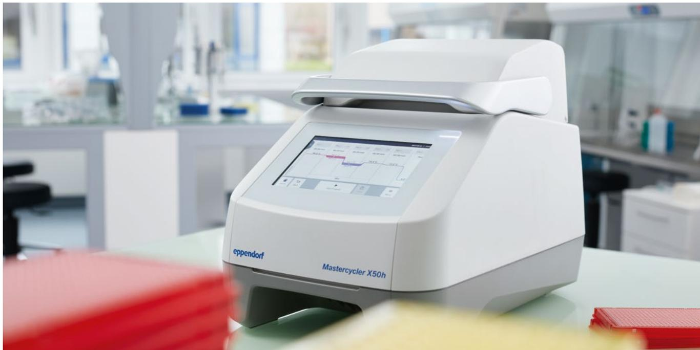
Si su aplicación implica edición de genomas, preparación de NGS library, clonación o detección de virus, necesita un termociclador PCR. La PCR de punto final tradicional se utiliza en prácticamente todos los laboratorios de biología molecular en los que es fundamental obtener un rendimiento óptimo y resultados rápidos y reproducibles.
