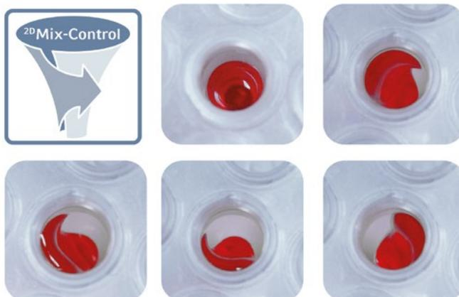
El 2<sup>D</sup>Mix-Control garantiza el mezclado eficaz de incluso los volúmenes más pequeños mediante un movimiento orbital amplio.
