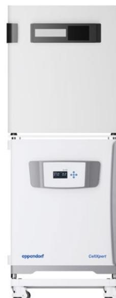
Los CellXpert C170i y C170 pueden apilarse junto con incubadores de CO<sub>2</sub> de Thermo Scientific®, PHCbi (antes Panasonic) y otros con el kit de apilado universal
