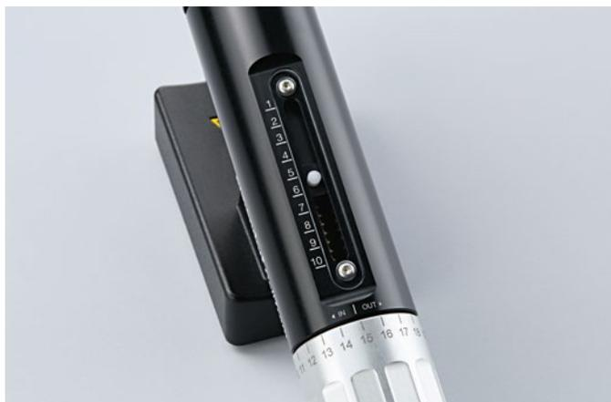
CellTram 4r Air: La capacidad de respuesta de la presión para diversas aplicaciones se puede ajustar mediante diferentes posiciones del pistón
