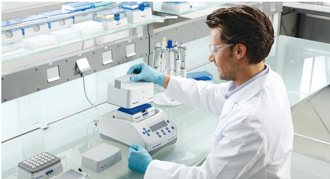
Todo laboratorio necesita calentar, enfriar y mezclar muestras. Purificación y análisis de ácidos nucleicos y proteínas, investigación de células y tejidos o perfiles de expresión génica: todas estas aplicaciones requieren un mezclador térmico.
