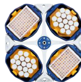
Adattatore universale 1 Adatto a Deepwell Plates e provette da 5 mL Eppendorf®.
