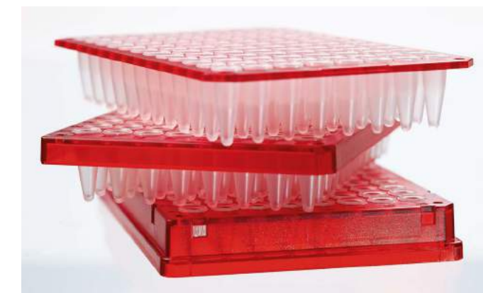
Diversi formati di supporto di piastre Eppendorf twin.tec®: unskirted (in alto), semi-skirted (al centro) e skirted (in basso).
