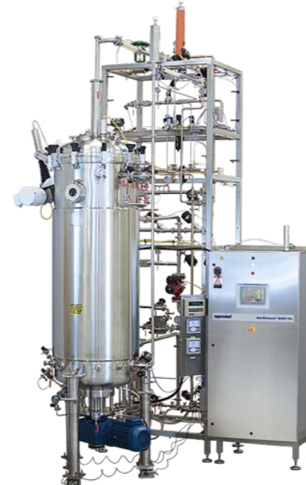
BioFlo® Pro SIP-Fermenter im Pilotmaßstab 45 – 1.200 L Arbeitsvolumen
