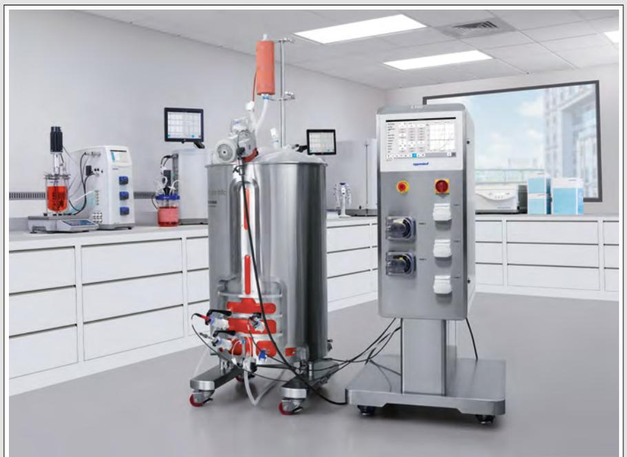
Das neue Bioprozess-Kontrollsystem BioFlo 720, hier mit 250-L-Einwegbioreaktor
