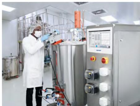
BioFlo 720 Bioprozess-Steuerungseinheit; kompatibel mit Thermo Scientific HyPerforma 5:1 Einwegbioreaktoren mit Arbeitsvolumen von 50 L und mehr
