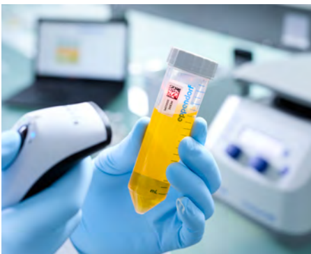
Einlesen des Datamatrix-Code mittels Barcode-Scanner
