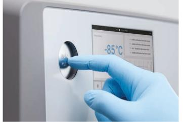
> Wenn Sie in Eile sind: Automatisches Druckausgleichsventil ermöglicht einen schnellen Probenzugriff'<sup>3</sup>
