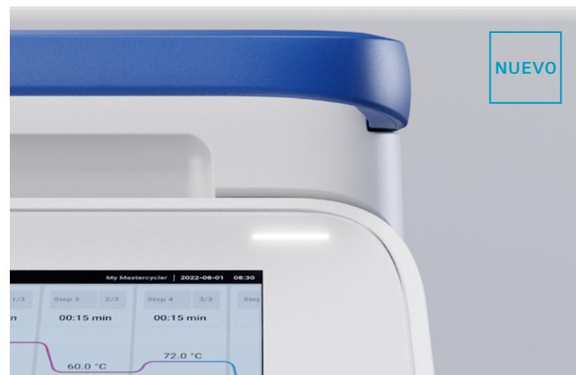
El Eppendorf Mastercycler® X40 conduce su PCR estándar a una nueva era. Con la calidad y el rendimiento conocidos del fiable bloque de aluminio combinado con un gradiente de 12 columnas para la optimización de la PCR.
