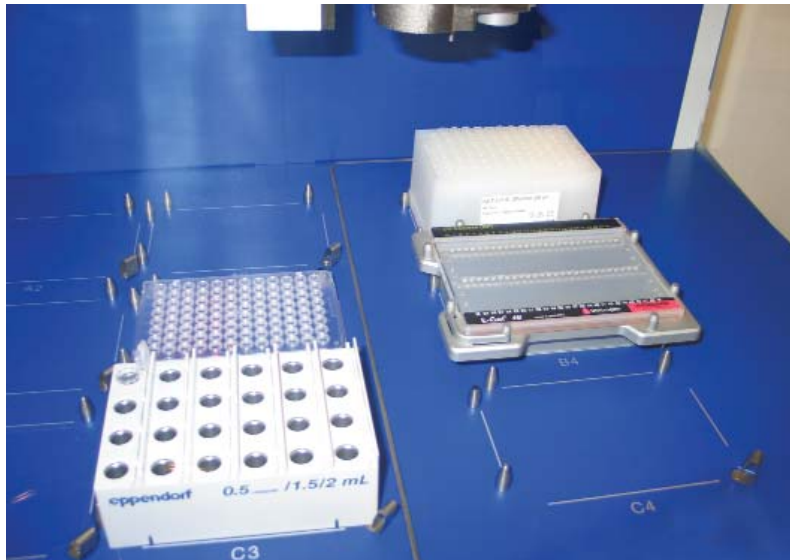
Bild 1: Bestückung des Worktables einer epMotion 5075 LH zum Beladen eines E-Gels 48.
