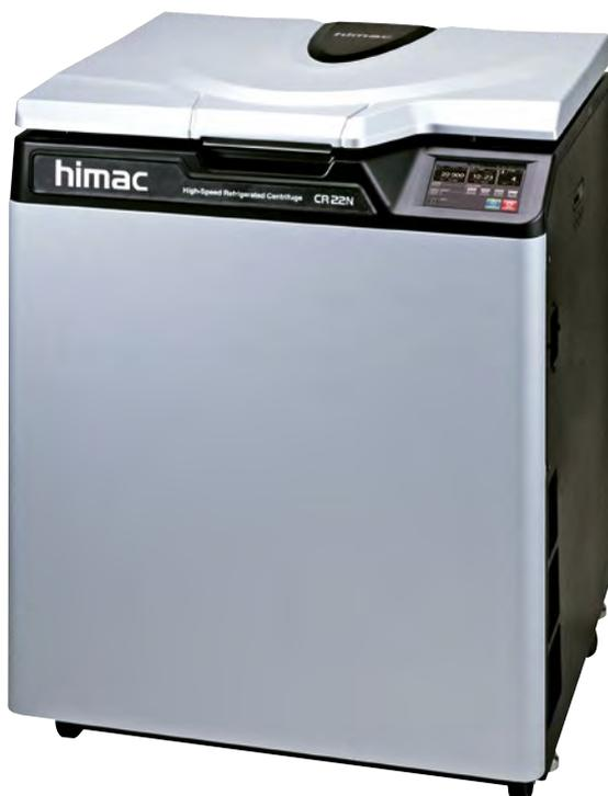
Ganz gleich, ob Sie bei Ihrer Arbeit Biomasse in Volumina von bis zu 6 L pro Lauf ernten, Zellen, subzelluläre Organellen oder größere Viren pelletieren oder Nukleinsäuren in bis zu 50-mL-Gefäßen extrahieren, fällen, konzentrieren und aufreinigen müssen – die Zentrifuge CR22N ist die optimale Lösung für Ihre täglichen Zentrifugieraufgaben.
