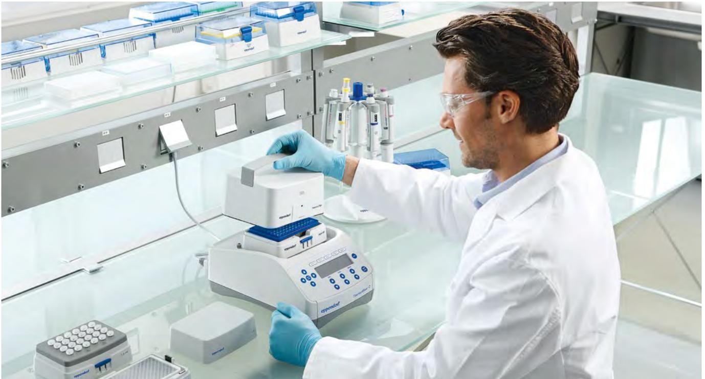
In jedem Labor müssen Proben erwärmt, gekühlt und gemischt werden. Ob bei der Aufreinigung oder Analyse von Nukleinsäuren oder Proteinen, bei der Forschung an Zellen oder Geweben oder der Genexpressionsanalyse – in jedem Fall wird ein Thermomixer gebraucht.
