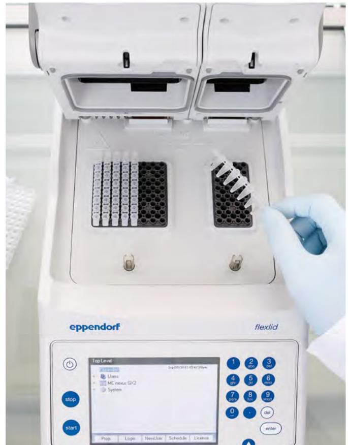
Führen Sie mit dem Mastercycler® nexus X2 zwei getrennte PCR-Anwendungen gleichzeitig durch
