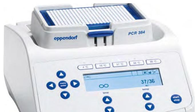
**Das ideale Gerät, wenn Sie bestimmte Temperaturen genau einstellen und halten möchten:** Mit dem Eppendorf ThermoStat C können Sie fast alle Ihre Laborgefäße heizen und kühlen. Für zusätzliche Vermeidung von Kondensatbildung bei kleinen Volumina empfehlen wir den Eppendorf ThermoTop (optional), einen Heizdeckel mit *condens.protect*-Technologie.
