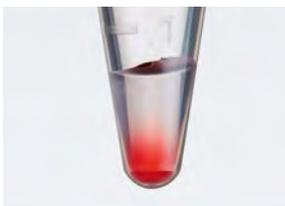
Keine optimale Probenmischung
