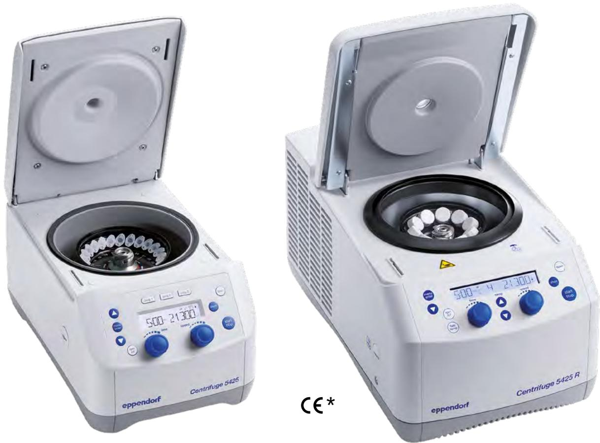
\* Die Centrifuge 5425/5425 R ist eine nicht automatische Zentrifuge zur Trennung von flüssigen Substanzgemischen aus dem menschlichen Körper und ist speziell dazu bestimmt, als Zubehör zusammen mit einem In-vitro-Diagnostikum verwendet zu werden, und dessen Verwendung gemäß seiner Zweckbestimmung zu ermöglichen. Dieses Produkt entspricht den Anforderungen der EU-Verordnung für In-Vitro-Diagnostika (IVDR) 2017/746.
