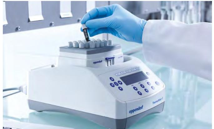
Nutzen Sie den Eppendorf ThermoMixer® C zum Heizen, Kühlen und Mischen Ihrer Proben. Ein breites Angebot an Eppendorf SmartBlocks bietet Flexibilität bei der Auswahl der Gefäße, von 384-well-Platten bis zu 50-mL-Gefäßen.
