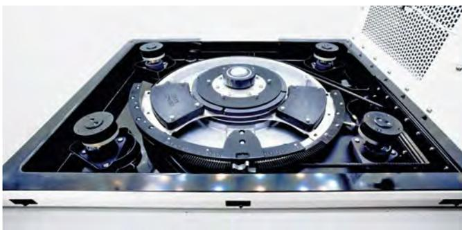
Eppendorf X-Drive: Die fünf exzentrischen Anlenkungen für die Schüttlerplattform sind mit höchster Präzision konstruiert, um langfristig eine dauerhafte, reproduzierbare Leistung zu gewährleisten. Die vier Wellen in den Ecken und die „Balance Master“-Technologie sorgen für vibrationsfreies Schütteln überall auf der Plattform, auch am Rand.
