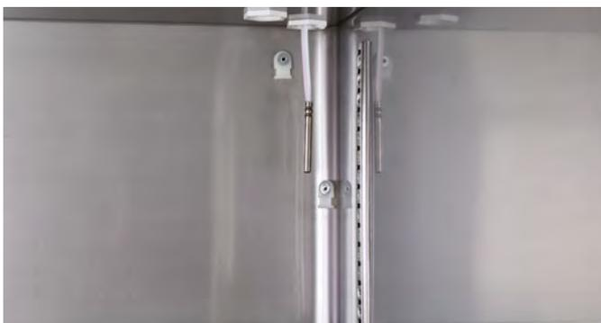
**Doppelte Absicherung Ihrer Proben?** Der eingebaute Temperaturfühler kann mit dem unabhängigen Temperaturüberwachungssystem VisioNize® sense ergänzt werden.
