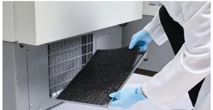
**Der Filter Ihres Ultratiefkühlgeräts muss gereinigt werden?** Einfacher Filterwechsel – Einfach die Filterabdeckung öffnen und einen sauberen Filter einsetzen.
