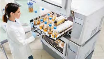
Nach oben gleitende Tür: platzsparend und leichter zu reinigen
