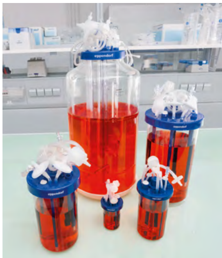
BioBLU c Single-Use Bioreactors von Eppendorf decken Arbeitsvolumina von 100 mL bis zu 40 L ab
