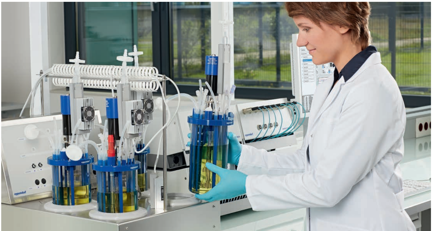
4-fache, individuelle Temperierung für Glas- und Einweg-Bioreaktoren: der DASGIP Bioblock
