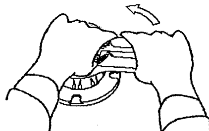
Fig. 3-14 Het verwijderen van de dekplaat
