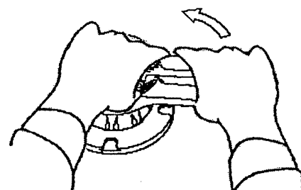
Fig. 3-14 Het verwijderen van de dekplaat
