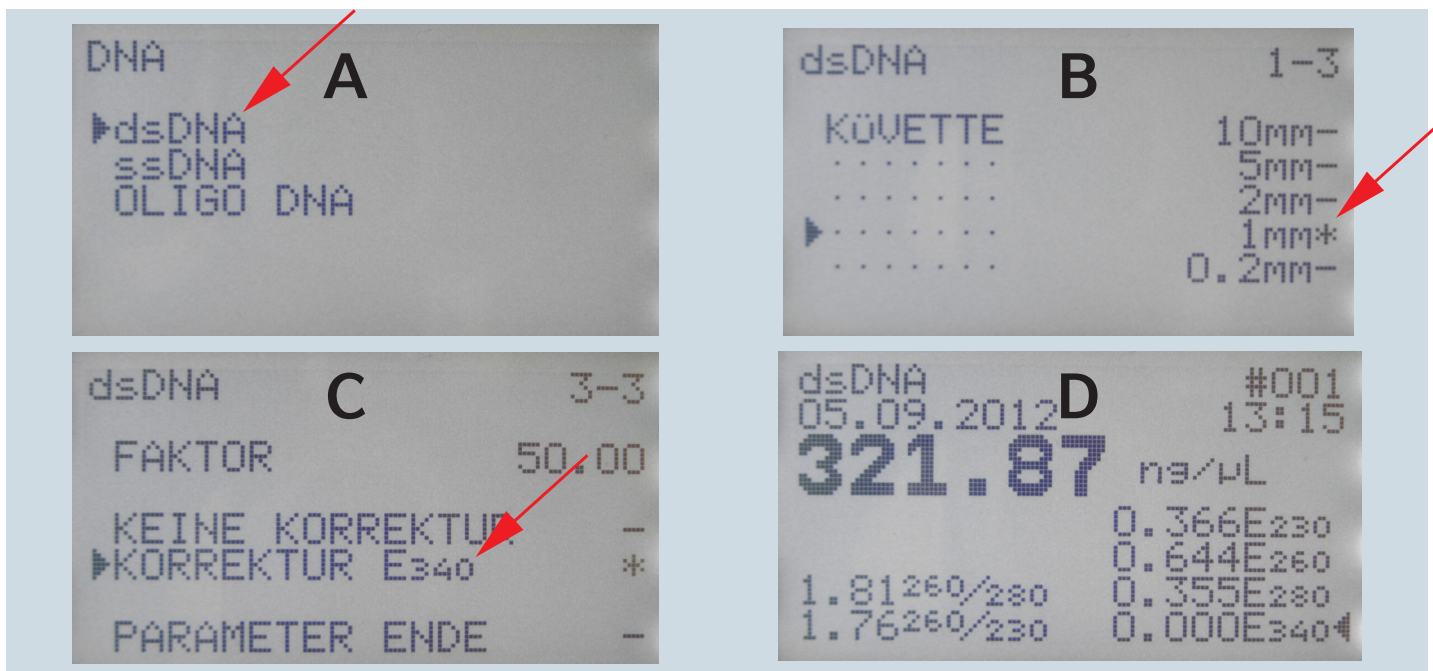
Abbildung 3: Einstellung der Parameter am BioPhotometer plus für die Anwendung des 1 mm Lichtweges und zur Aktivierung der Hintergrundkorrektur:
