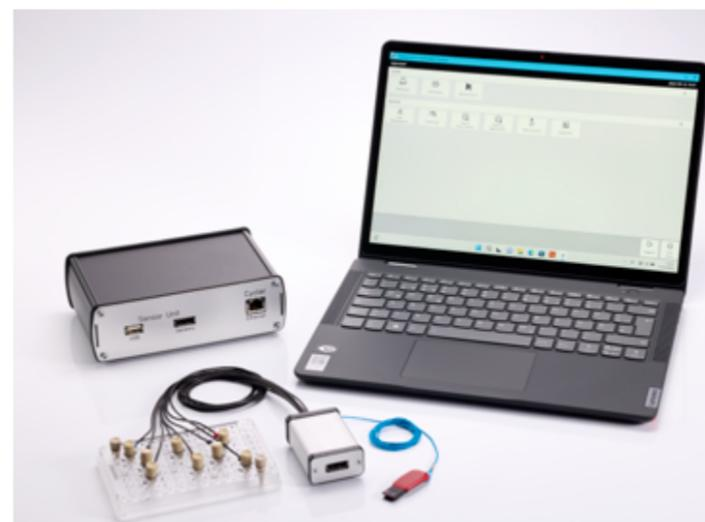
Die Temperaturverifizierung mit einem Multi-Sensor-System ermöglicht eine schnelle und zuverlässige Beurteilung der Cyclerleistung.
