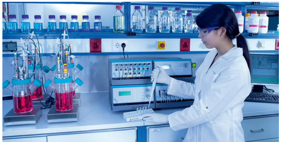
Abb. 1: Paralleles Benchtop-Bioreaktorsystem für die Zellkultur
