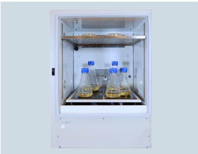
**Geeignet für Anwendungen mit niedriger bis mittlerer Geschwindigkeit:** Haftfolienkissen auf speziellen Plattformen sind für Flachbodengefäße und Anwendungen mit niedriger Geschwindigkeit (max. 200/250 rpm bei einem Orbit von 2/1 Zoll (50/25 mm)) eine Alternative zu Halteklammern. Sie sind wiederverwendbar und können einfach durch Abziehen von der Oberfläche neu positioniert werden.
