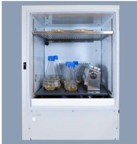
**Parallele statische Kultivierung:** Ein abnehmbarer, höhenverstellbarer Edelstahl einlegeboden über der Schüttlerplattform ist im Lieferumfang enthalten; zusätzliche Einlegeböden sind erhältlich.
