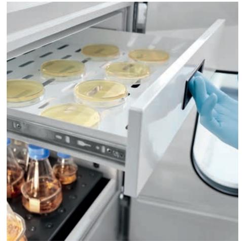
**Schutz gegen Austrocknen von Proben und Verdunstung des Mediums:** Die optionale Kulturschublade kann z. B. verwendet werden, um Agarplatten vor dem Austrocknen zu schützen und die Viabilität von Klonen zu maximieren.
