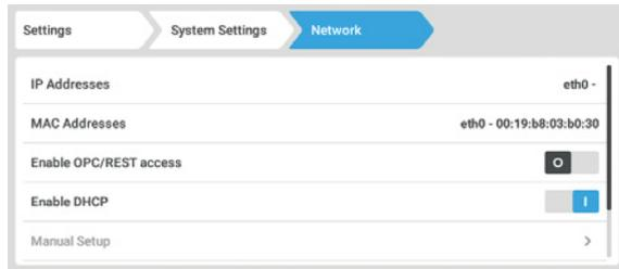
4. Das Gerät lässt sich mit Hilfe des DHCP-Netzwerkprotokolls einfach in das Netzwerk einbinden. Schieberegler *Enable DHCP* aktivieren.
