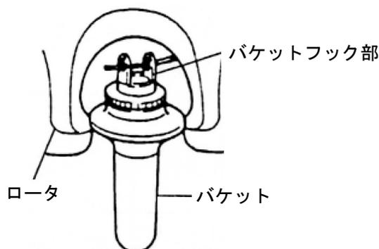
バケットのフックをロータのピン部にかけます。ロータとバケットの番号を合わせてください。
