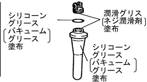
使用後は、バケットは、水道水またはpH5～9の中性洗剤の希釈液で洗い、蒸留水ですすぎます。キャップを取ったまま、空气中で乾燥します。乾燥後、バケットの表面にシリコングリース（バキュームグリース）、ネジ部には潤滑グリス（ネジ潤滑剤）、Oリング、ガスケットにはシリコングリース（バキュームグリース）を薄く塗布し、乾燥した雰囲気中で保管してください。
