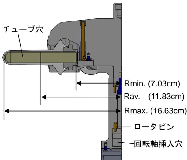
図 7-2 P28S2 用バケットの断面図
