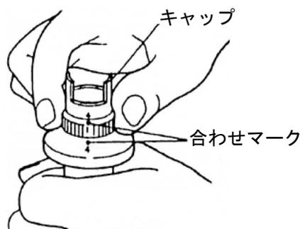
キャップは、バケットと同じ番号を組み合わせてねじ込み、キャップの下端がバケットに突当るまで締め付け、キャップとバケットの合わせマークを合致させてください。
