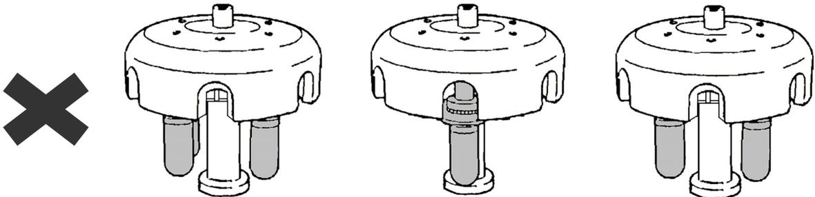
バケットのキャップの締め付け、ロータへの取り付けは、確実に行ってください。
