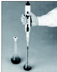
Fig. 4-6: Aspiration de liquide
