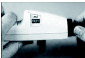
Fig. 4-5: Réglage du volume
