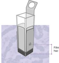
Filtro para la altura del haz de luz de 15 mm
