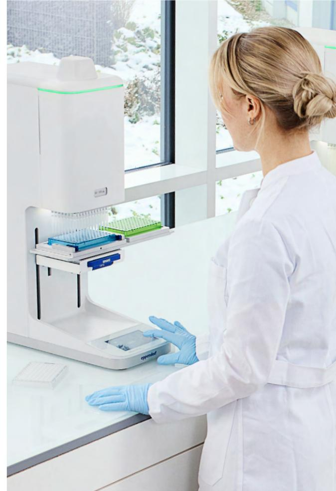
**Opcional:** retire o añada puntas del rack reload (trabaje siempre con columnas de puntas completas).
