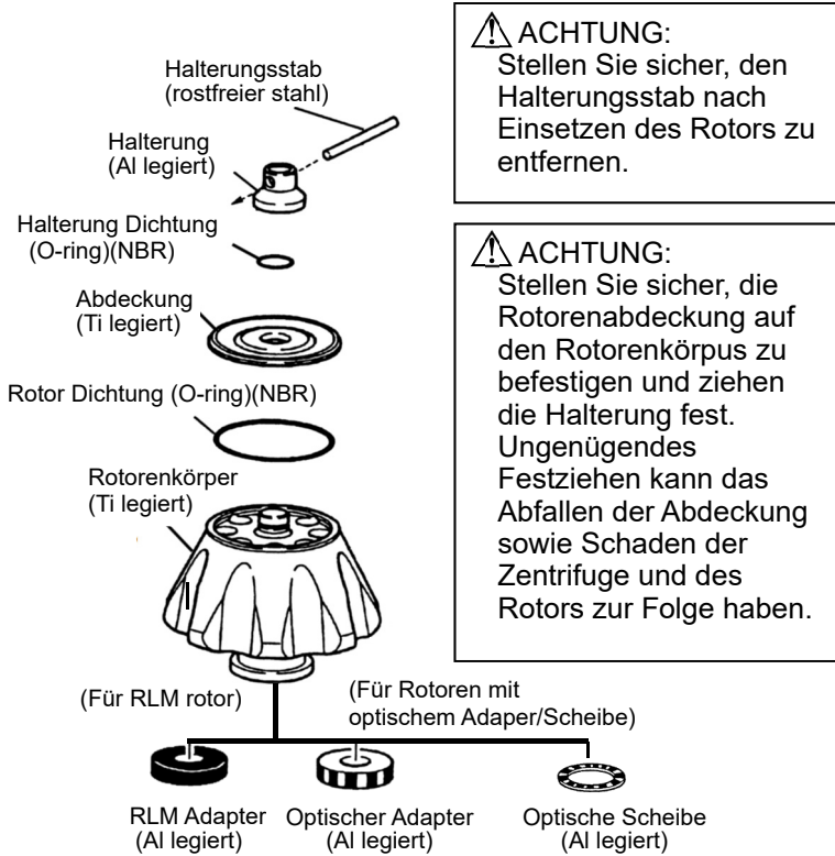
Abb.1-1. Konstruktion des P100AT2 Rotors
