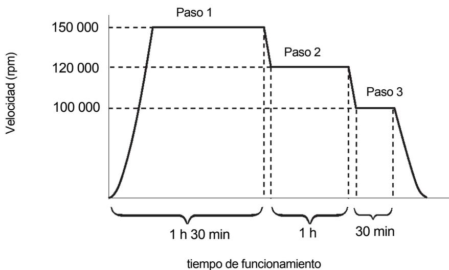
Ilustración 2-3-2 Un funcionamiento del modo por pasos típico
