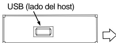
Inserte la unidad flash USB en el conector USB de conexión externa (lado del host) en el lado derecho de la centrifugadora.
