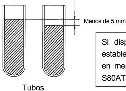
Si dispone de un rotor S140AT, S100AT5 o S50A, establezca la diferencia de nivel de menisco aproximada en menos de 3 mm; si dispone de un rotor S110AT o S80AT3, defínala en menos de 4 mm.
