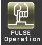
Cuando mantiene pulsado este botón, la centrifugadora acelera hasta la velocidad configurada a la velocidad de aceleración máxima. Cuando suelta esta botón, comienza la desaceleración. Esta característica resulta de utilidad para retirar las muestras adheridas a las paredes interiores de los tubos.
