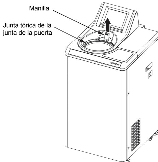
Ilustración 3-4-1 Retirada de la junta tórica de la junta de la puerta
