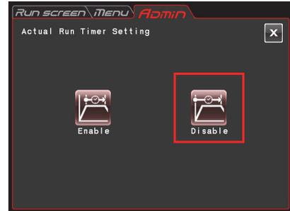
Ilustración 2-4-6 (3) Pantalla Actual Run Timer Setting
