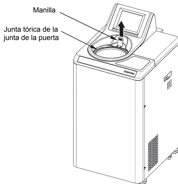
Ilustración 3-4-1 Retirada de la junta tórica de la junta de la puerta
