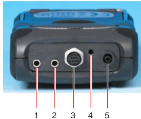
Imag. 4-3: Puntos de conexión, vista superior
