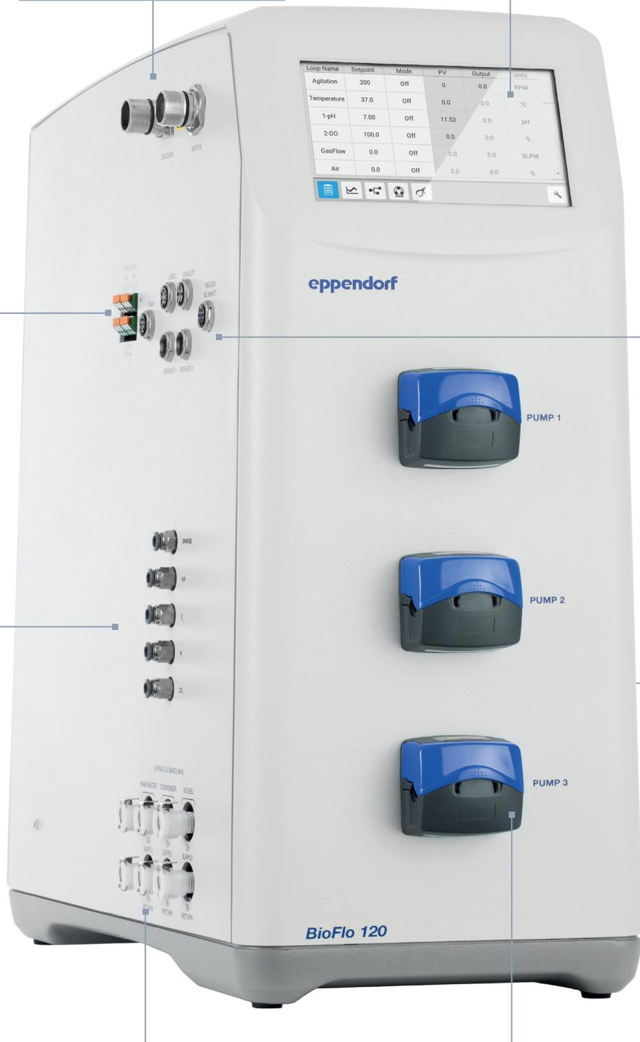
Tres conexiones analógicas de entrada/salida definidas por el usuario. Selección entre 0-5 V, 0-10 V y 4-20 mA dependiendo del equipo
