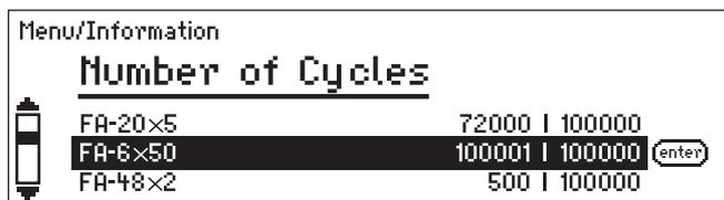
2. Seleccione un rotor con las teclas de flecha del menú ▲ o ▼. Confirme con la tecla **menu/enter**.
