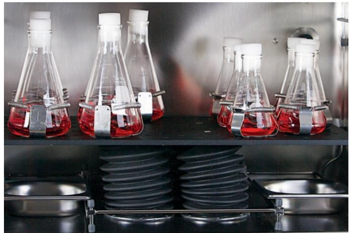
El accionamiento de triple excéntrica, famoso a nivel mundial, ofrece un movimiento estable, uniforme y sin vibraciones. Está conectado a la plataforma de agitación mediante cuatro varillas encapsuladas y ubicado debajo de la cámara, garantizando que el calor generado por el accionamiento no afecte al ambiente crítico dentro de la cámara
