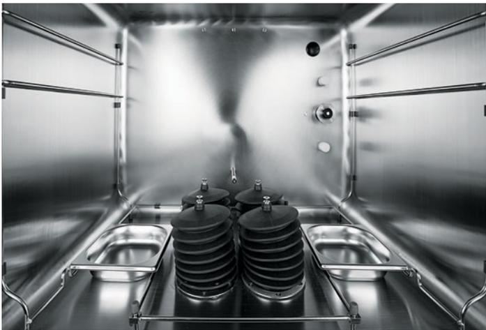
La cámara de acero inoxidable sin soldaduras fácil de limpiar elimina una fuente de contaminación potencial
