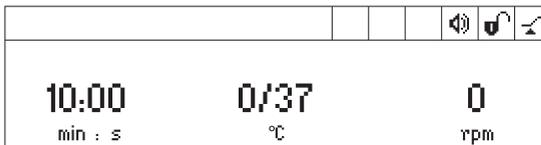
2. Ajuste la duración del control de temperatura con las teclas de flecha **time**.
