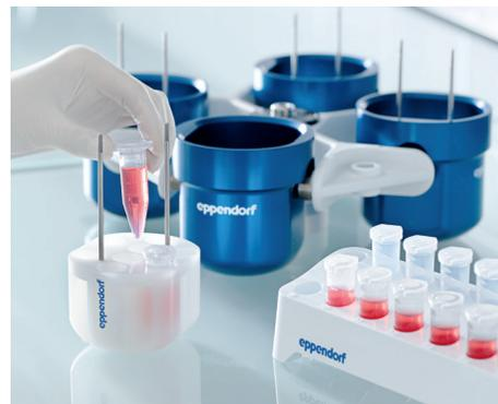
Adaptadores optimizados para los rotores basculantes existentes
