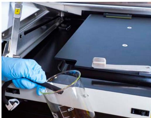
**Protección contra derrames y fácil limpieza:** El accionamiento de triple excentricidad Innova está protegido contra derrames gracias a la exclusiva bandeja antiderrame drenable con esquinas redondeadas. La bandeja antiderrame también puede utilizarse como reservorio de agua para reducir la evaporación del medio.
