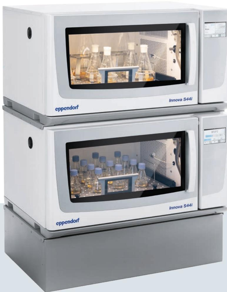
**Control verdadero con interfaz táctil:** Todos los valores teóricos y actuales pueden consultarse de un vistazo; restricción del acceso para cambiar los ajustes mediante la gestión de usuarios
