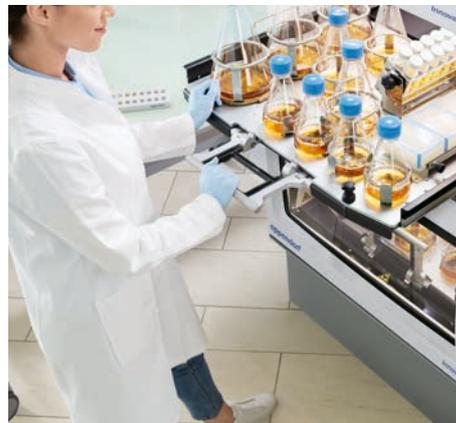
**Fácil manejo de la puerta y la plataforma:** La puerta, que ahorra espacio, facilita el mantenimiento y el acceso a las muestras. La plataforma extraíble puede manejarse con una sola mano.
