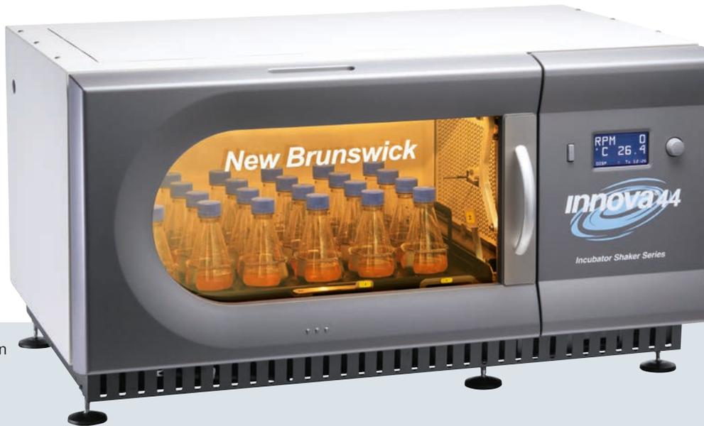
**Menos ruido en el laboratorio:** El accionamiento Innova de triple excentricidad con contrapeso y alta resistencia garantiza un funcionamiento silencioso ( $< 65\text{ dbA}$ )
