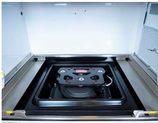
**Construido para durar:** El accionamiento Innova de triple excentricidad con contrapeso, con tres ejes que soportan el peso, proporciona un funcionamiento sin vibraciones ni problemas con cargas elevadas durante años. No debe confundirse con los denominados accionamientos de «triple contrapeso» que suelen venir con un solo soporte de peso.
