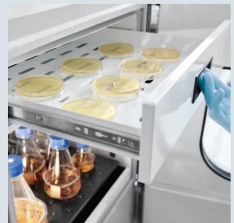
**Protección contra la desecación de muestras y la evaporación del medio:** El cajón de cultivo opcional puede utilizarse para proteger las placas de agar de la desecación. Bandeja antiderrames integrada y monitorización de la humedad opcional.
