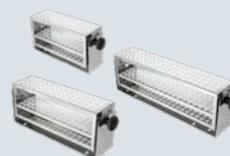
**Los racks para tubos** para plataformas universales vienen en 18 formatos para tubos de 8 a 30 mm de diámetro. Los pomos laterales permiten ajustar rápidamente el ángulo de agitación o liberar el rack insertado del soporte para facilitar su transporte hasta la mesa de trabajo. Los racks incluyen un soporte de altura de tubo y están fabricados en acero inoxidable. Los insertos de plástico ayudan a retener los tubos y evitan que giren en el rack.
