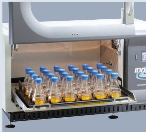
**Fácil manejo de la puerta y la plataforma:** La puerta, que ahorra espacio, se desliza hacia arriba y no estorba para facilitar el acceso a todas las muestras y las labores de mantenimiento.
