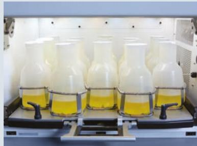
**Agite más:** La plataforma, el accionamiento y la cámara del Innova S44i están optimizados para una gran capacidad de recipientes y una alta carga de líquido. Por ejemplo, puede alojar hasta 13/15 matraces Thomson Ultra Yield<sup>®</sup> de 2,5 L o 36/39 matraces Erlenmeyer de 500 mL en una plataforma universal/dedicada.
