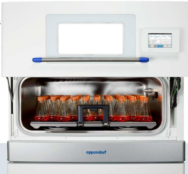
**Cámara de acero inoxidable:** Diseño higiénico conforme a la norma EN ISO14159:2008; con pocas piezas internas y sin rueda motriz, hendiduras, chapas de cubierta, cables ni aletas calefactoras en el interior
