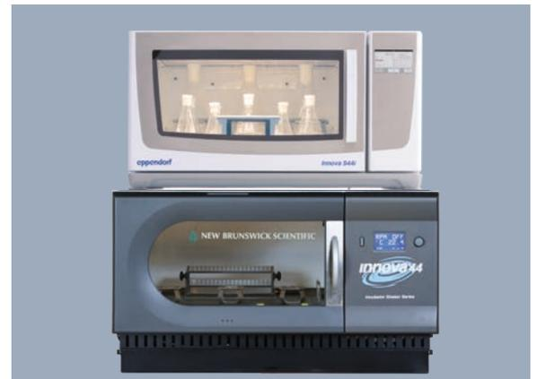
**Actualice fácilmente su laboratorio:** Simplemente apile su nuevo Innova S44i sobre su actual agitador incubador Innova 44/44R. Amplíe su capacidad de agitación y su potencial de aplicación sin ampliar el espacio requerido.
