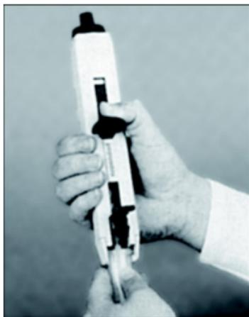
Fig. 4-3: Insertion des Varitips
