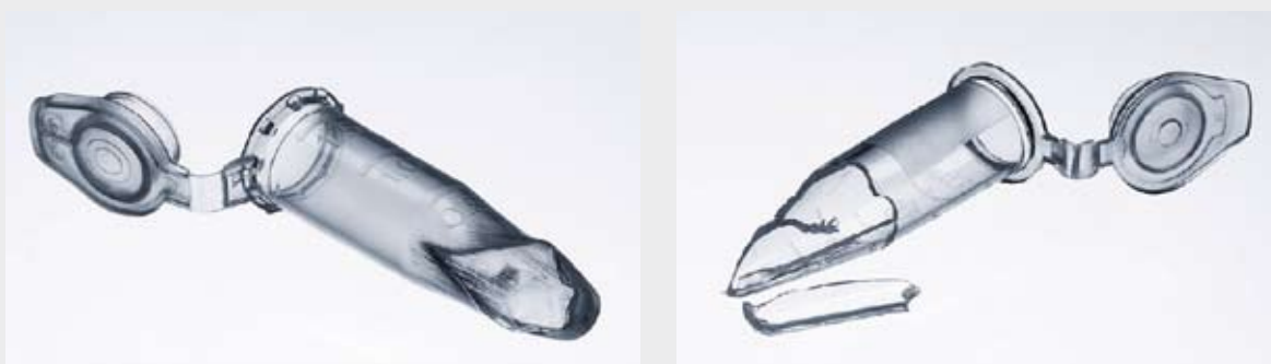
Figure 2 : Tubes concurrents endommagés au cours de la centrifugation par des contraintes trop élevées (G et A).
