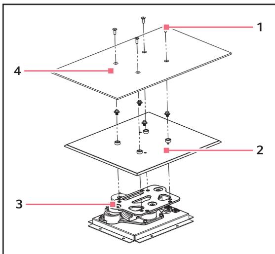
Fig. 4-2: Installation de la plate-forme et du couvercle d'égouttage
