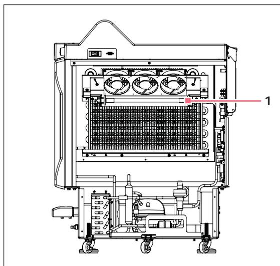
Fig. 3-1: Lampes UV (sur le côté de l'agitateur)
