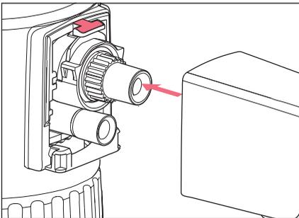
1. Enfiler la soupape de distribution dans la soupape de sortie sur le bloc de valves.
