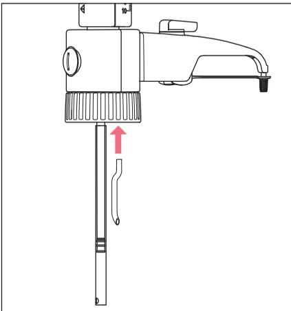
1. Insérer le tube de recirculation à côté du tuyau d'aspiration télescopique.
