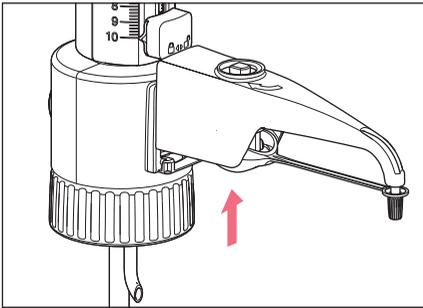
2. Appuyer vers le haut le boîtier du bras pour canule sur le bloc de valves.
