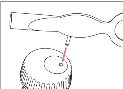
1. Enfiler la clé d'ajustage de la clé universelle dans le recouvrement ajustable.
