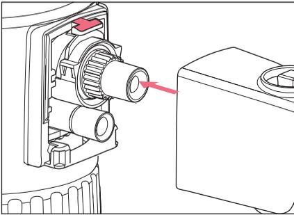
1. Appuyer une peu vers le bas la soupape de distribution dans le boîtier.
